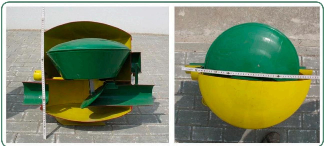
Abbildung 11 Regulierungseinheit für Drainagen entwickelt 1989 in der DDR (Foged et al. 2012)
