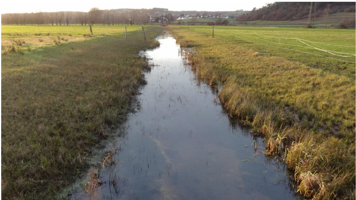
Abb. 4: Die Grabenabflachung erleichtert die Grabenpflege und verhindert, dass Vögel darin verenden.
